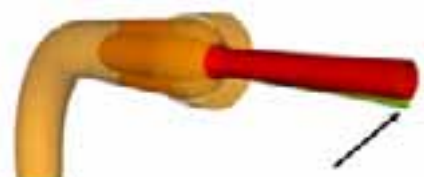
Abb. 3: Simulation der Freistrahlsströmung nach einem 90° Krümmer
