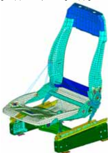
Abb. 7: Einfache Struktur, um modale Dämpfungen zu berechnen
