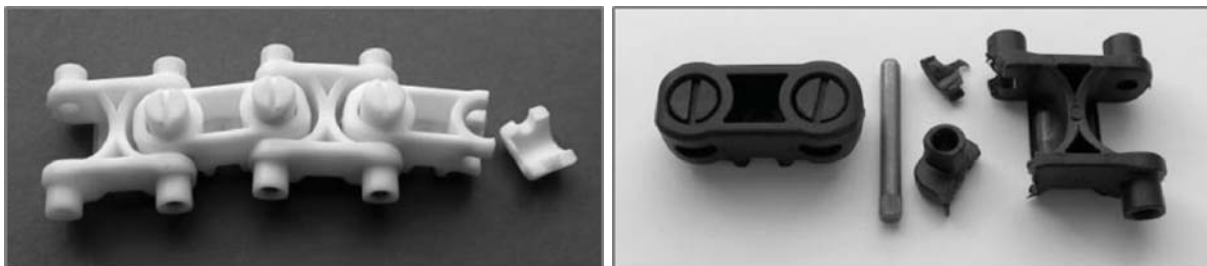
Abb. 3: Typische Bruchbilder an Zugelementen von Gleitketten [10]
