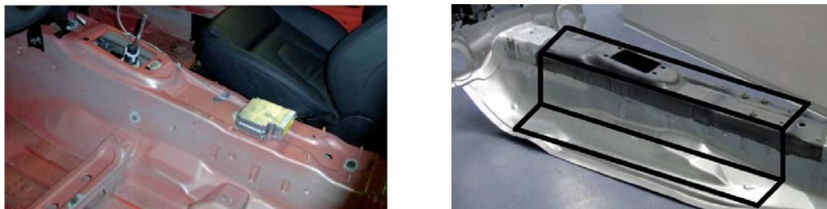
Abb. 6: Beispiel eines Fahrzeugtunnels (links) und die Skizze der vereinfachten Struktur (rechts)
