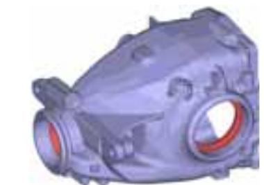
Abb. 7: Gestalt des neuen Hinterachsgetriebes (BMW 1er)
