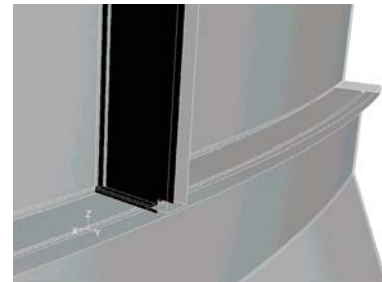
Abb. 6: Unverschweißte Flächen an den Verbindungen
