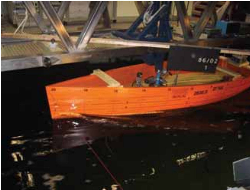
Abbildung 8: Schleppversuch mit dem Modell einer 10m Yacht
