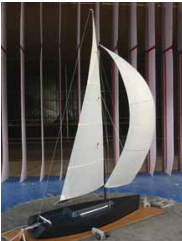
Abbildung 9: Maßstäbliches Modell einer 10m Segelyacht im Windtunnel der University of Auckland, Neuseeland
