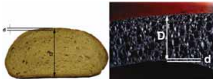
Abbildung 1: Vergleich der Hautdicke von Brot (links) und Zellgummi (rechts)
