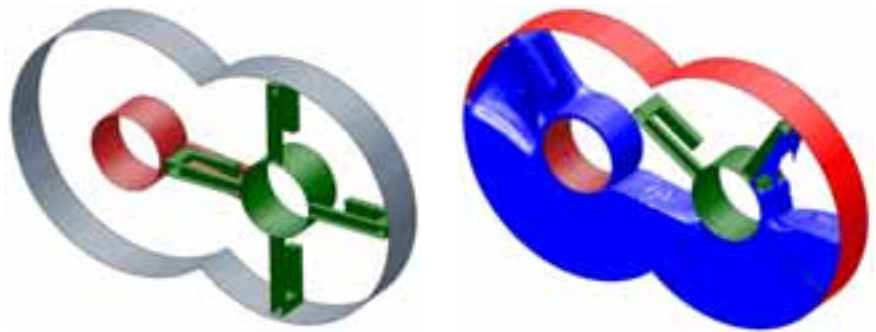
Abb. 2: Viele Rührer haben zwei Mischkörper, die sich um ihre Achsen drehen; dabei überschneiden sich oft die Bahnen der Arme, wie im linken Bild zu sehen ist. Außerdem ist der Spalt zwischen den Teilen, die aneinander vorbeigleiten, oft sehr klein. Hier wurde die drei-dimensionale Simulation der Strömung in einem Modellmischer durchgeführt, bei dem eine Achse vier Arme und die andere nur einen Arm hat; die Letztere dreht sich viermal schneller als die erste. Die Flüssigkeit ist sehr zäh, wie aus dem rechten Bild, in dem die freie Oberfläche nach ca. \frac{1}{4} Umdrehung dargestellt wurde, zu erkennen ist.
