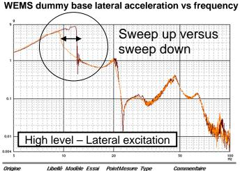
Origine Libellé Modèle Essai PointMesure Type Comme R57 TEST\_X\_lim TF QL6AX 232X Fondamental R58 TEST\_X\_lim TF QL6BX 232X Fondamental
