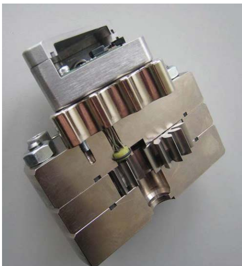
Abb. 1: Geometrie des Volumenmessgeräts
