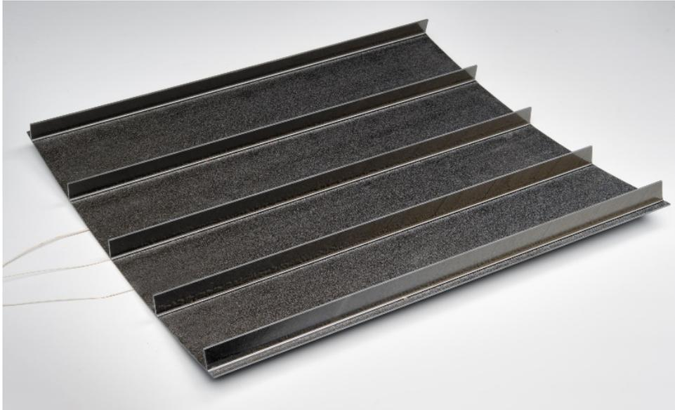
*Abb. 1: Demonstrator aus neu entwickeltem Material und integrierten optischen Sensoren. Die Komponente wurde unter Verwendung einer automatisierten Faserpositionierung (AFP) hergestellt und der Herstellungsprozess mit einer Prozesssimulation unterstützt*
