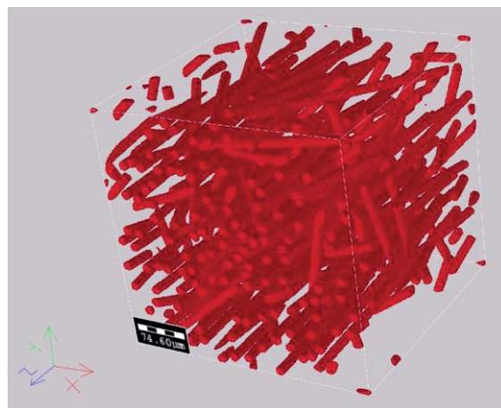
Abb. 2: Mikrostruktur eines glasfaserverstärkten Polymers,  $512^3$  Voxel [10]
