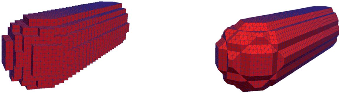
Abb. 5a: Tetraedernetz einer Einzelfaser, links ungeglättet und rechts geglättet
