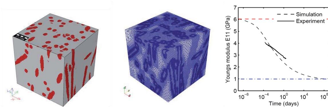
Abb. 7: Vergleich von simulierten und gemessenen Relaxationskurven (Labordaten von Robert Bosch GmbH zur Verfügung gestellt), Voxel Bild (links), FE Netz (mitte), Relaxation des Elastizitätsmoduls in x-Richtung (rechts)
