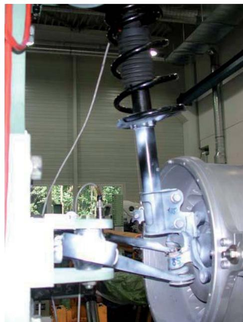
Abb. 9: Links: Achsschenkel; Rechts: Prüfstands Aufbau.
