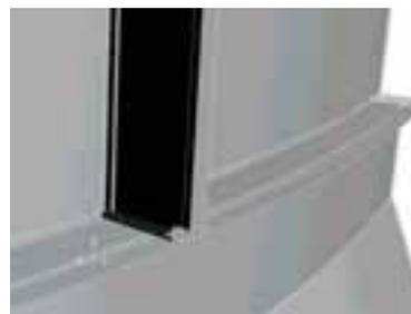
Abb. 6: Unverschweißte Flächen an den Verbindungen
