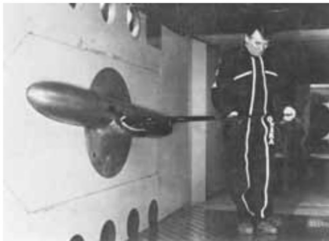
Bild 1: AMP-Modellflügel im transonischen ONERA S2MA Windkanal
