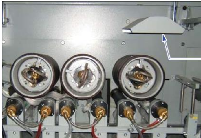
Les blocs de craquage avec cylindres d'entraînement, refroidis par circulation d'eau
