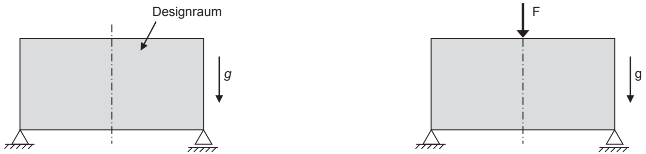
Abb. 3: Modell für Topologieoptimierung unter reiner Eigengewichtsbelastung (links) und Modell mit zusätzlicher konstanter Einzelkraft F (rechts)
