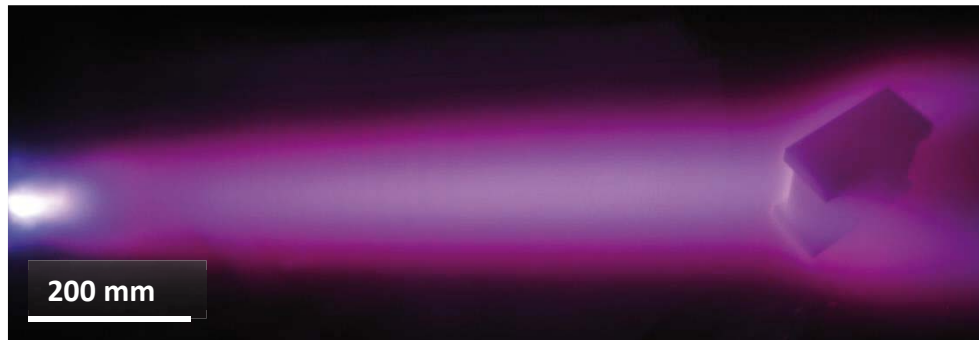
Abbildung 2: Freier Plasmastrahl beim PSPVD-Prozess zwischen Pistolenaustritt (links) und zu beschichtendem Bauteil (rechts) bei einem kontrollierten Umgebungsdruck von 1.5 mbar
