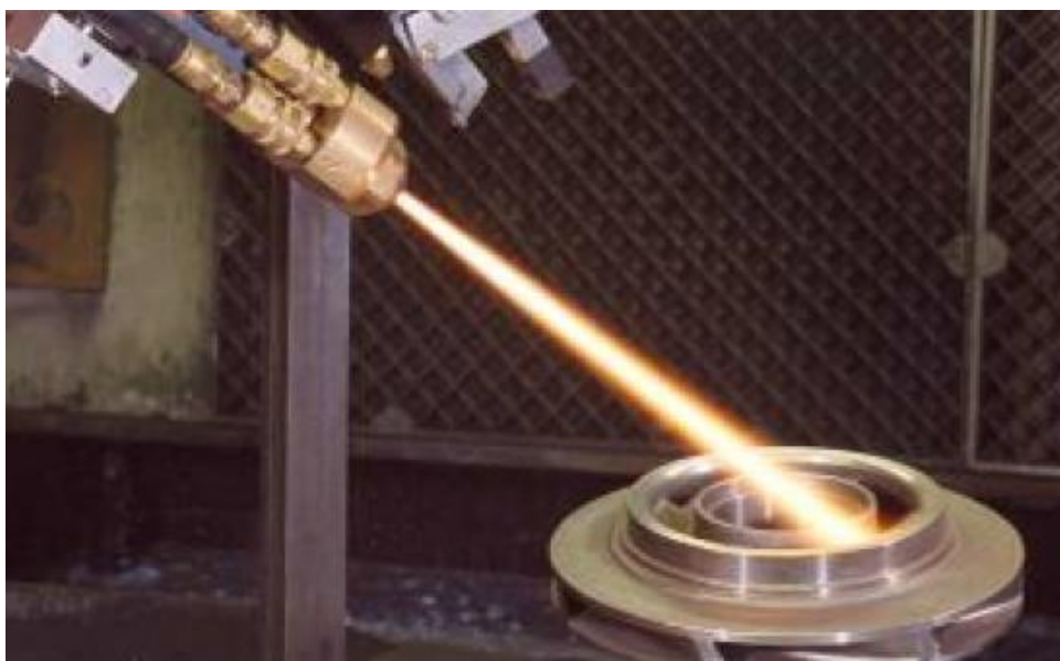
Abbildung 1: Thermischer Spritzprozess zur Beschichtung eines Pumpenlaufrades
