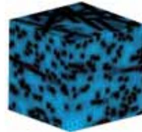
Virtuell erzeugte Mikrostruktur eines faser-verstärkten Kunststoffs (Fraunhofer-ITWM)
