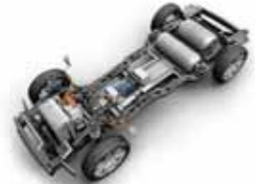
Plattform eines Brennstoffzellen-fahrzeugs mit zwei Wasserstoff-Hochdruckbehältern (Adam Opel GmbH)
