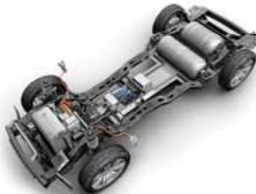
Abb. 14 Plattform eines Brennstoffzellenfahrzeugs mit zwei Wasserstoff-Hochdruckbehältern
