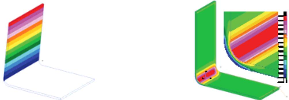
Abb. 5: L-Profil Spring-in-Verformung und Eigenspannungen
